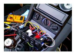
Anm.: Auf der linken Seite im Fußraum befindet sich das Steuergerät für die Fensterheber. Teppich lösen, Polster entfernen und dann .... Grau-Blaues ... (Braun-Gelbes) Kabel trennen, danach mit dem Braun-Gelben Kabel des AV32 (Schalterseite Anm.: Steuergerät-Seite) und mit dem Blau-Gelben Kabel (Türseite) verbinden.
