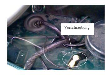
Jetzt das Modul testen und falls alles funktioniert die Kabel verlegen und die Abdeckungen schließen.
