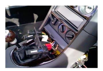
Grau-Grünes (*Anm.: Grau-Gelbes*) Kabel trennen, danach mit dem Braun-Rosa Kabel des AV32 (Schalterseite) und mit dem Rosa-Blauen Kabel (Türseite) verbinden.
